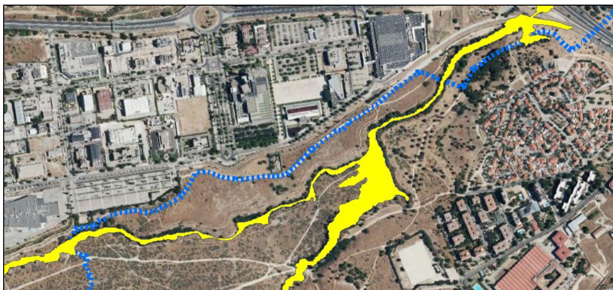
Figura 11. Identificación de Zonas Inundable para T500 en el arroyo de los Meaques en el ámbito del PEI. Fuente: IGN y C.H del Tajo
